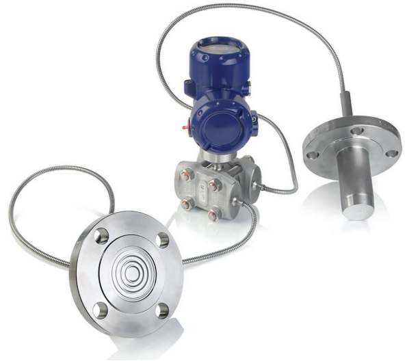
Transmissor de pressão diferencial WIKA montado em dois selos diafragma do tipo flange através de um capilar
