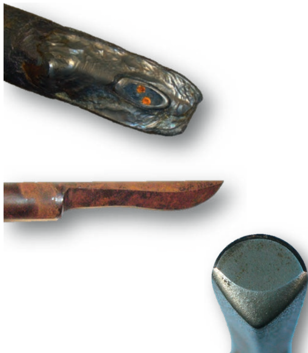
Uszkodzenia osłon termometrycznych obciążonych ściernie (przykłady)
