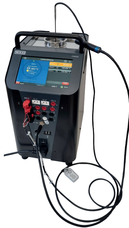
CTD9350 jako aplikacja z zewnętrznym termometrem referencyjnym
