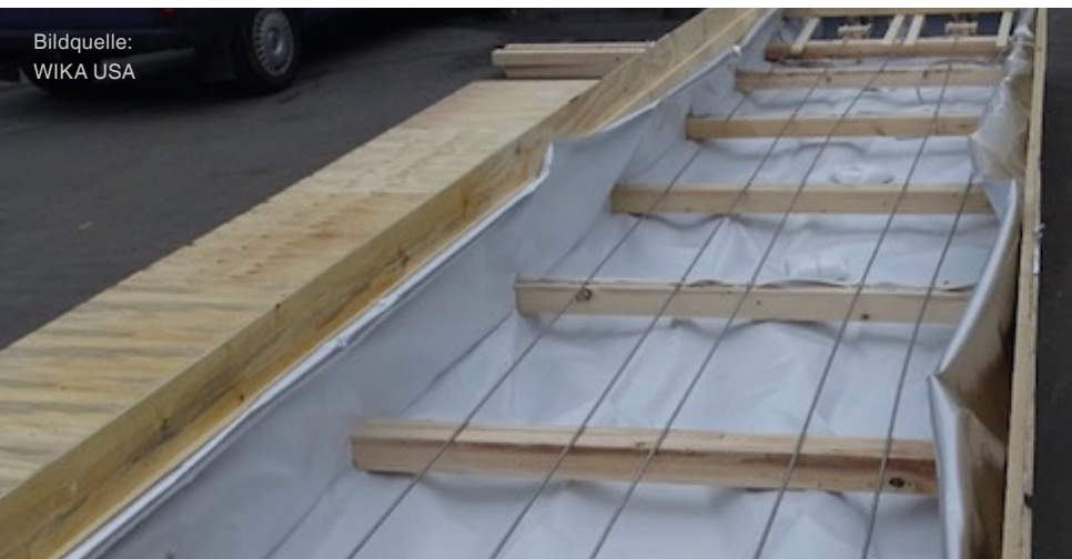
Das 20 m lange Miniatur-Stufen-Thermoelement Typ TC96-M wurde für den Transport in einer speziell angefertigten Kiste untergebracht.
