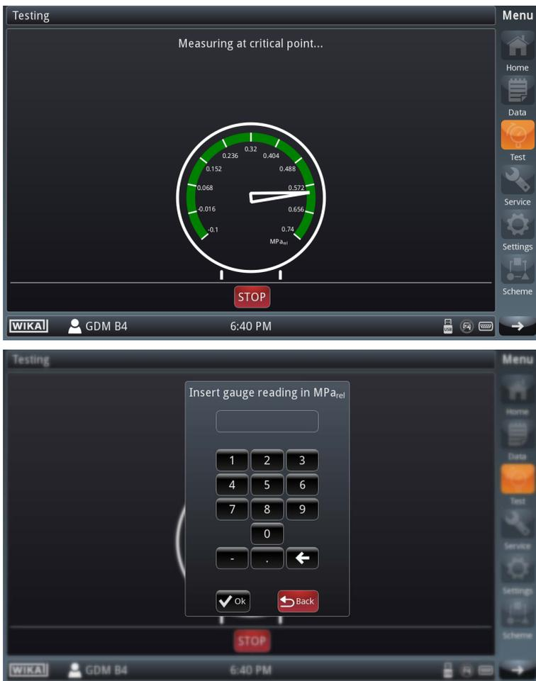
在校准压力下进入指针位置后，接近满刻度值，此时需要重新确认。
