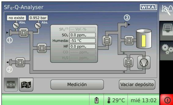
2. Seleccionar la cámara de gas a la cual bombeare de regreso el gas de medición (solo si se seleccionó la función de bombeo de retorno).
