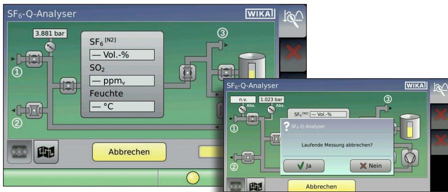
2. Gasraum auswählen, in den das Messgas zurückgepumpt werden soll (nur wenn Rückpumpfunktion ausgewählt wurde).
