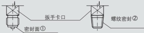
紧固扭矩取决于使用的密封类型。为了使测量仪表能够尽可能准确地定位，应该使用带有 LH-RH 左右旋转接头或螺母连接。
