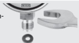
Para el cierre de las conexiones de los manómetros con roscas cilíndricas en la superficie de cierre ① se debe instalar juntas planas, arandelas o juntas perfiladas WIKA. Para roscas cónicas (por ejemplo, roscas NPT) se realiza el cierre en la rosca ② con material de cierre complementario, como por ejemplo, cinta PTFE (EN 837-2).
