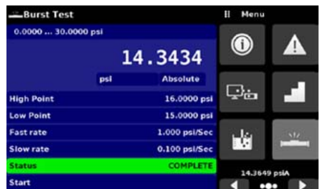
图 6.4.12-B - 破裂测试完成
