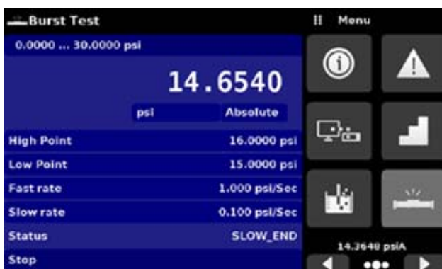
图 6.4.12-A - 正在进行破裂测试
