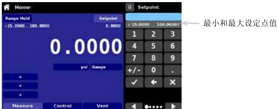
图 6.4.1.2.1 - 使用数字键盘输入设定点
