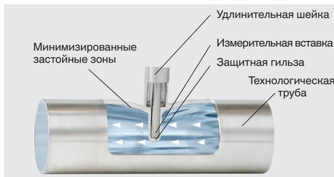
Запатентованная асептическая конструкция прямооточного корпуса TW61 позволяет минимизировать застойные зоны и обеспечивает контактное измерение температуры и гибкость монтажных положений благодаря функции самодренажа.
