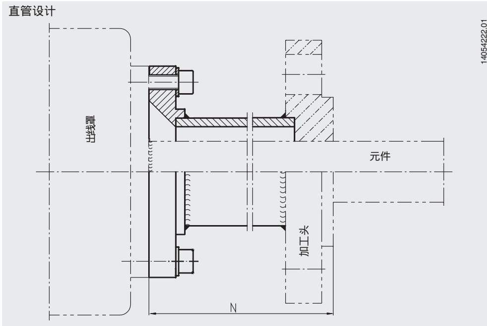
可分离式螺纹接头（可旋转）
