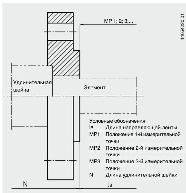
В многоточечных термомпарах Тх95-А-В ленточной конструкции защитная гильза, в зависимости от спецификаций, вводится через фланец, а потому одновременно выполняет функции удлинительной шейки. Многоточечный термометр Тх95-А-В и его защитная гильза конструируются и изготавливаются в соответствии со спецификациями конкретного заказчика.
