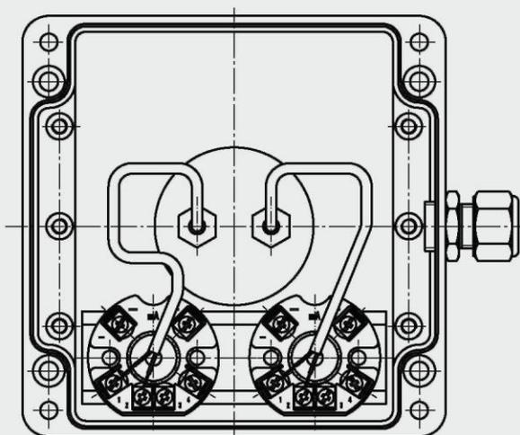
Преобразователь на клемму
