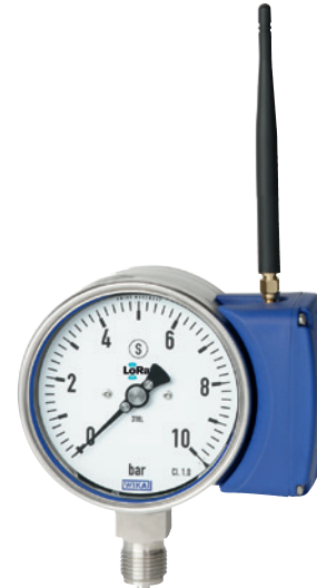
Manometro a molla Bourdon compatibile con l'IIoT, modello PGW23.100
