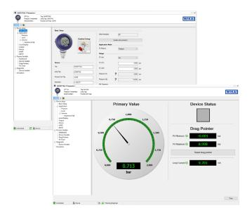
Für das Ausgangssignal HART® ist ein DTM nach dem FDT-Standard verfügbar. Der DTM stellt eine selbsterklärende und übersichtliche Bedienoberfläche für alle Einstell- und Überwachungsvorgänge der Transmitter bereit. Ebenfalls lassen sich zu Testzwecken Prozesswerte simulieren sowie die Parametrierdaten archivieren.
