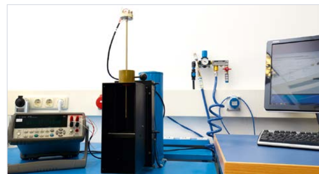
Bild 4: Vorrichtung zur Messung der Ansprechzeit in Luft
