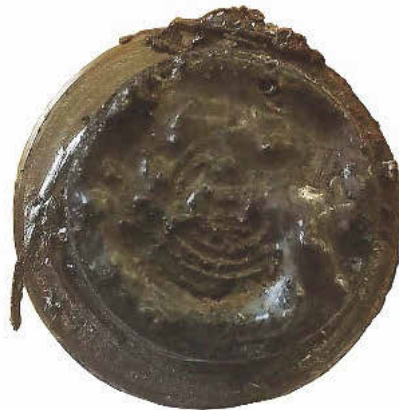
Membran-Abrieb in Folge von Druckspitzen oder oszillierenden Druckverläufen (links), eine von Korrosion und starker Verschmutzung durch den Messstoff beschädigte Membran (Mitte) und eine Membran mit Produktanhaftungen, die das Messergebnis beeinträchtigen können (rechts)
