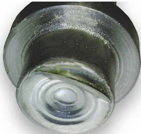
Membran-Abrieb in Folge von Druckspitzen oder oszillierenden Druckverläufen (links), eine von Korrosion und starker Verschmutzung durch den Messstoff beschädigte Membran (Mitte) und eine Membran mit Produktanhaftungen, die das Messergebnis beeinträchtigen können (rechts)
