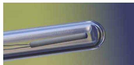
Bild 4: Die Stück- oder Typprüfungen von Messwiderständen erfolgen in hochreinem Quarzglas unter Luftzufuhr
