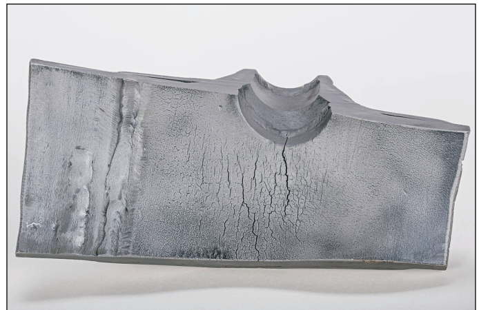
Abb. 2 Spannungsrissskorrosion an einem Edelstahlbauteil (Bild: CEphoto, Uwe Aranas)
