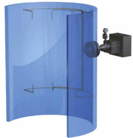
Führung der Thermoelemente im Inneren des Reaktors: Die spitzenempfindlichen Thermoelemente werden mit speziell entworfenen Befestigungssystemen so im Reaktor verlegt, dass ein minimaler Fussabdruck im Prozessfluss hinterbleibt.
