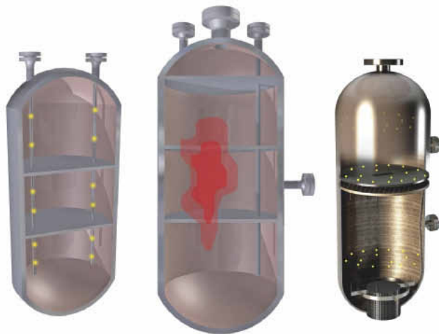
In Reaktoren können sogenannte Hitzenester entstehen (Mitte). Um solche Hot Spots zu detektieren, kann man entweder die Messpunkte linear entlang eines Schutzrohres (links) oder radial im Reaktor (rechts) verteilen.
