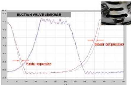
Abb. 1: Leckage am Kompressorventil – Vergleich Gut- und Fehlerzustand
