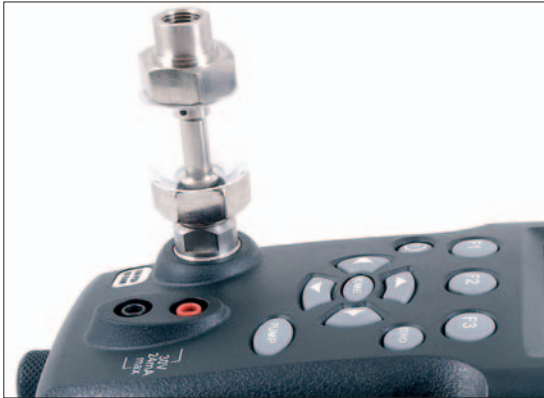
Schmutzabscheider: So lässt sich die integrierte Pumpe vom verschmutzten Kalibriergegenstand trennen.
