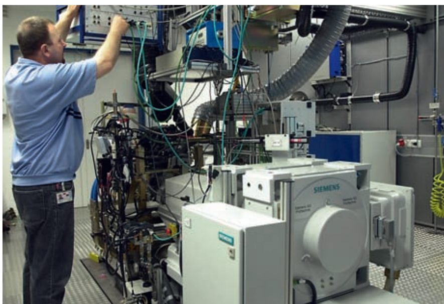
Inbetriebnahme der Messboxen im Motorenprüfstand bei Volkswagen in Wolfsburg.
